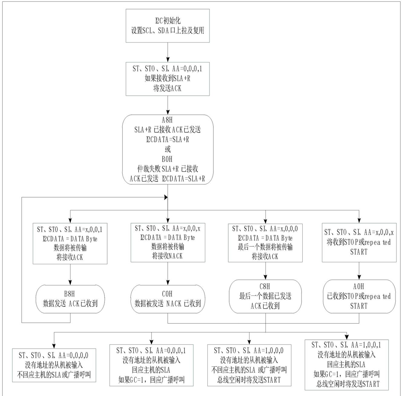
图 11.3-4 从机发送模式流程与状态图
