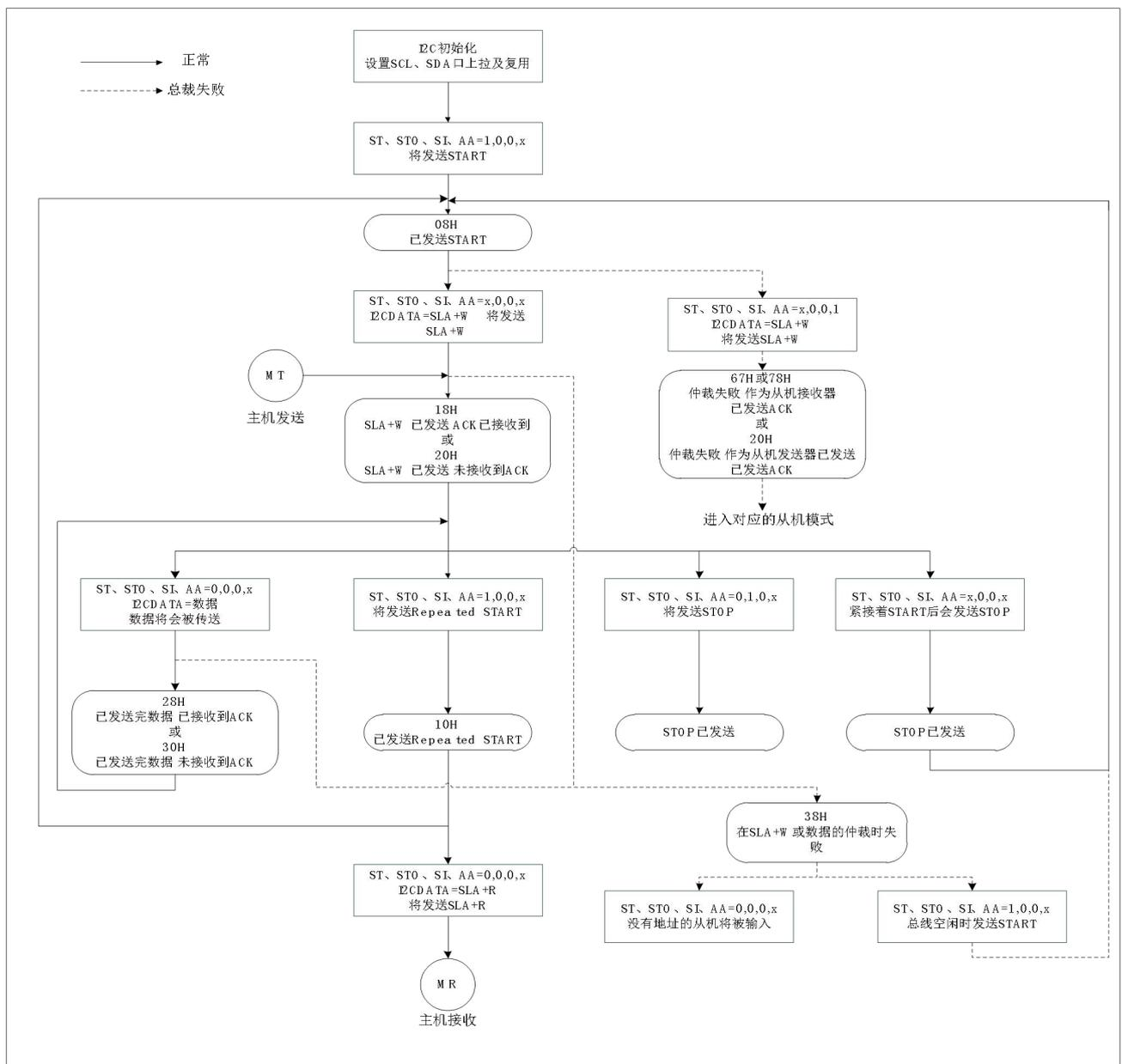
图 11.3-1 主机发送模式流程与状态图
