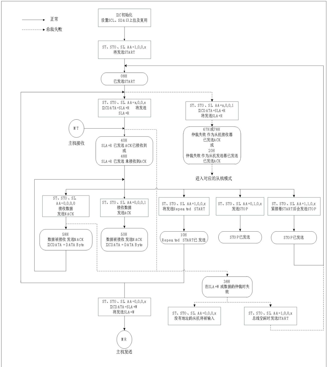
图 11.3-2 主机接收模式流程与状态图
