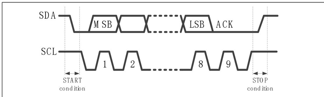
图 11.2-2 I2C 总线数据协议图
